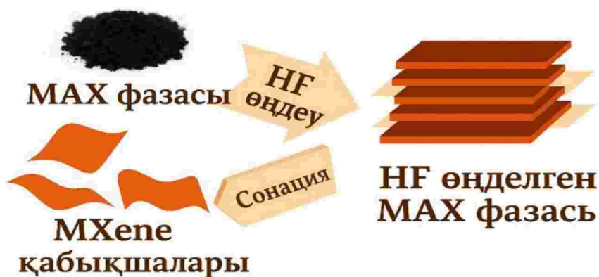
2.1 сурет - MAX фазасынан макзен парақшаларын алу схемасы
